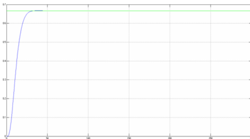
Рисунок 3 – Переходный процесс в САУ температуры с ПД-законом управления
